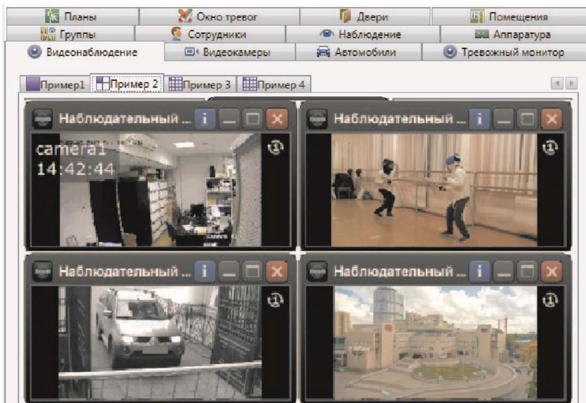
Вкладка состоит из таблицы (количество столбцов и строк определяется в настройках), в ячейках которой отображается информация определенной видеокамеры.
